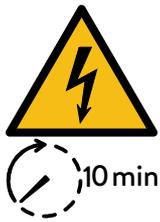
Warnung vor elektrischer Spannung. Nach dem Ausschalten 10 Minuten warten (Entladezeit der internen Energiespeicher).
